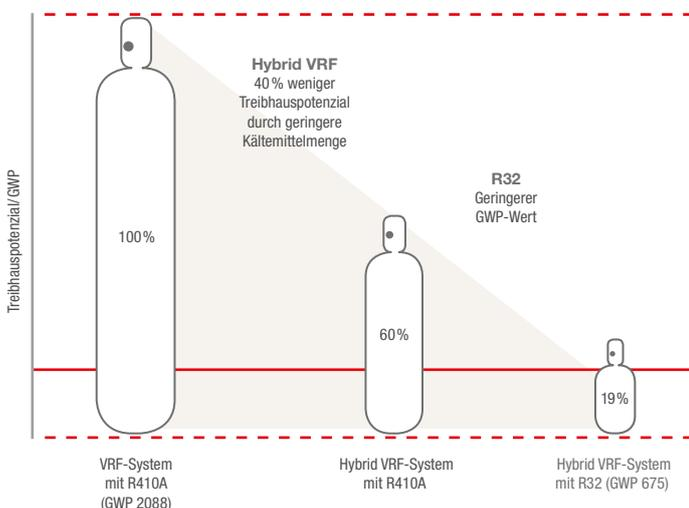
Durch den Einsatz eines Hybrid VRF-Systems mit dem Kältemittel R32 lässt sich schon heute das von der EU für 2030 geforderte CO<sub>2</sub>-Äquivalent erreichen.
