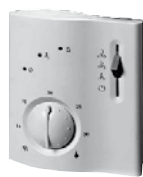
RCC 10 – 70250051 Für 2-Wege-Systeme mit externer Heizen/Kühlen-Umschaltung
