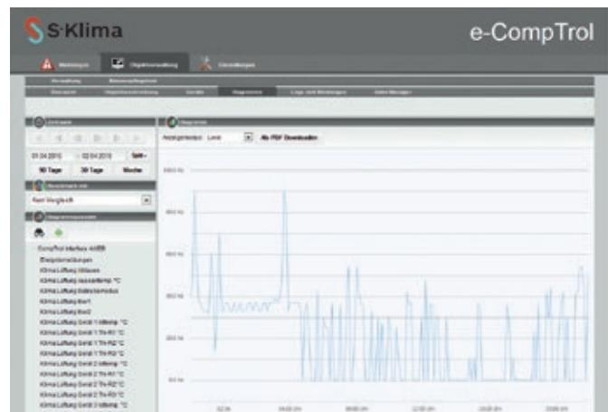
Über den Tag wird die Taktung durch den hohen Wärmeeintrag ausgelöst. Die Mindest-Heizleistung der Anlage ist höher als die Anforderung. In der Nacht hingegen ist der Wärmeeintrag zu vernachlässigen, so dass die Mindestleistung in diesem Zeitraum passend ist.
