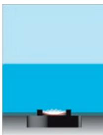
Der Schwinger geht in eine negative Amplitude. Durch die Trägheit des Wassers wird ein Vakuum erzeugt.
