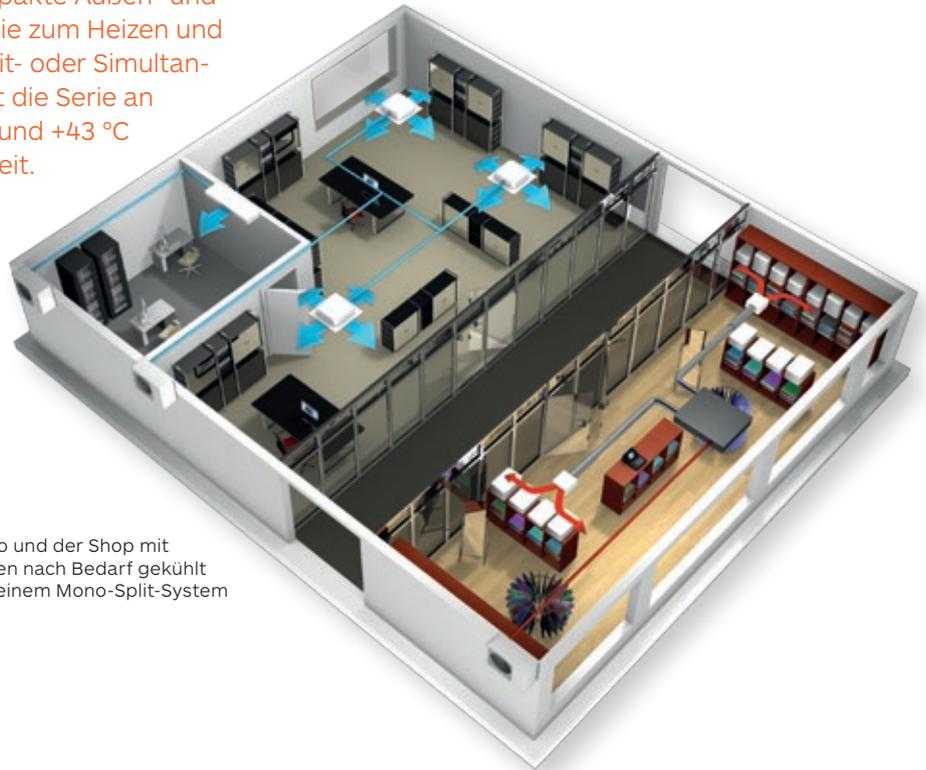
In dieser Darstellung werden das Großraumbüro und der Shop mit Simultan-Duo- bzw. Simultan-Trio-Split-Lösungen nach Bedarf gekühlt oder geheizt. Ein kleiner Technikraum wird mit einem Mono-Split-System ganzjährig gekühlt.
